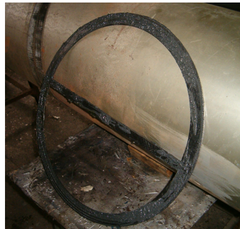
Slika br. 15. Isečen grafitni zaptivač Teadit GE 1520
