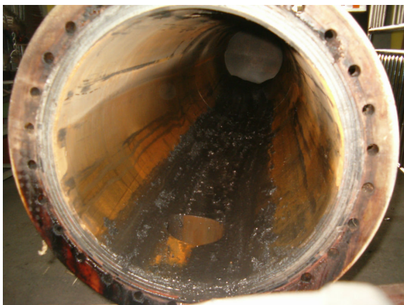
Slika br. 12. Talog mulja u omotaču RT
