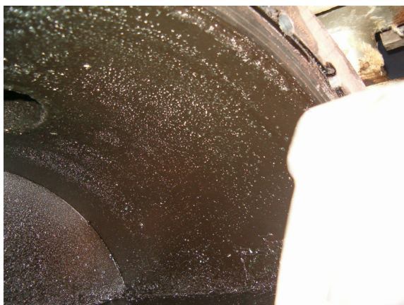
Slika br. 5. Zaostali metalni opiljci u komori RT
