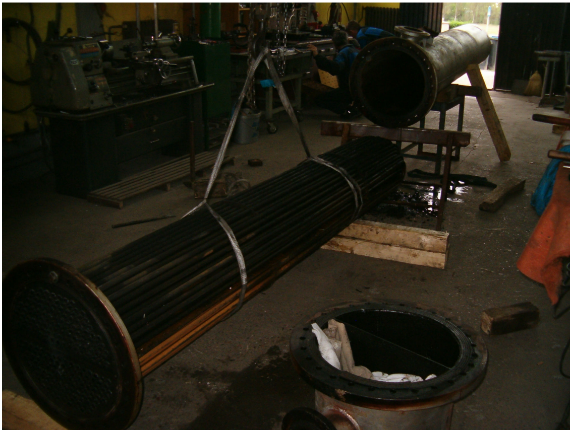
Slika br. 11. Potpuno demontiran RT 0519: omotač, cevni registar i glava
