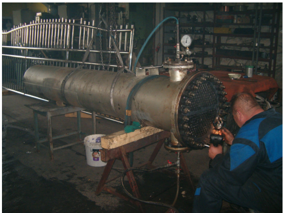
Slika br. 16. Detaljno kontrolno ispitivanje cevne ploče
