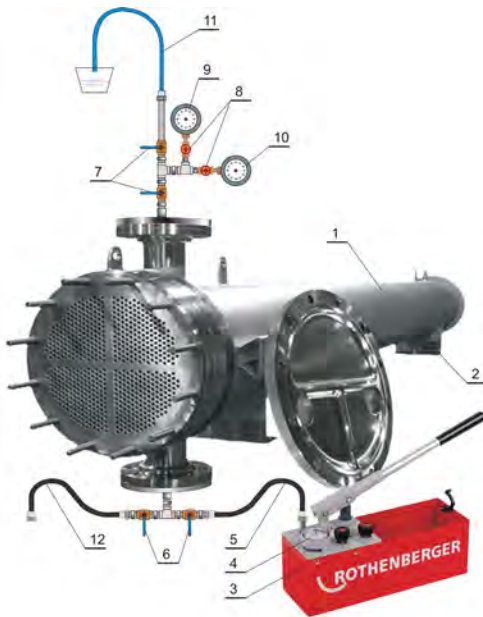
Sl. 4.127. Standardno hidrostatičko ispitivanje dobošastog razmenjivača toplote sa strane doboša i kontrola spojeva cevi i cevne ploče
