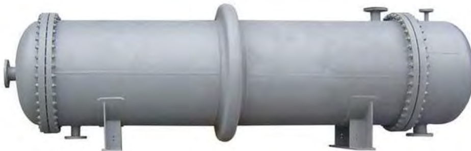
Sl. 4.10. Dobošasti razmenjivač toplote, TEMA tip BEM, kompenzator sa U-mehom
