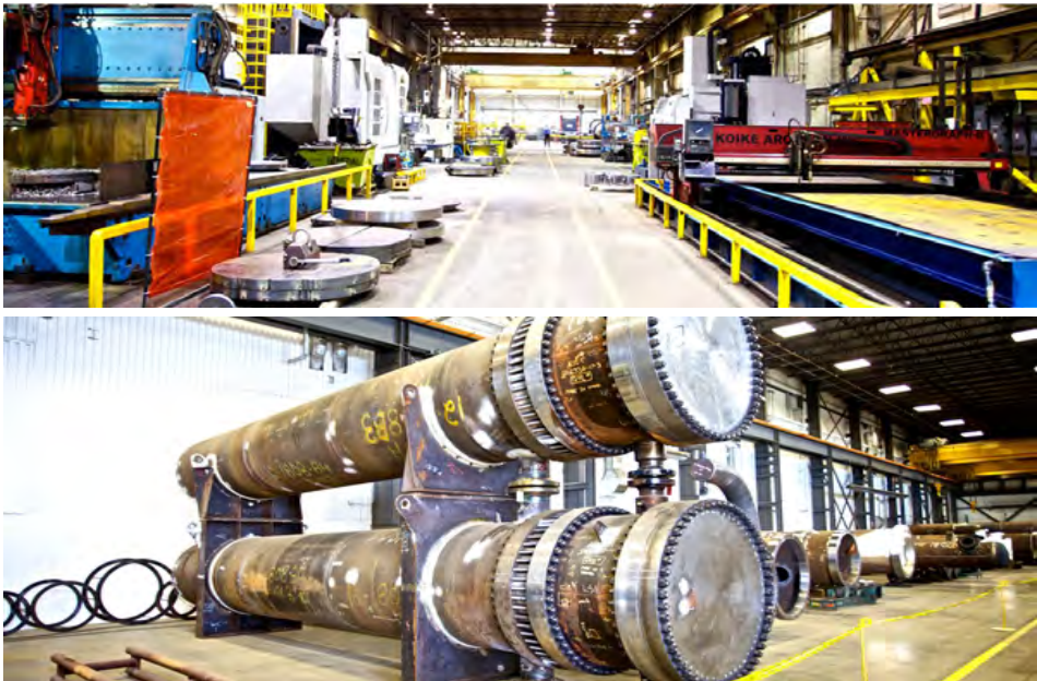
Sl. 4.1. Dobro opremljena radionica za izradu dobošastih razmenjivača toplote ALTEX, Kanada. Gore, prednji deo hale za izradu komponenti, dole montažni deo hale.
