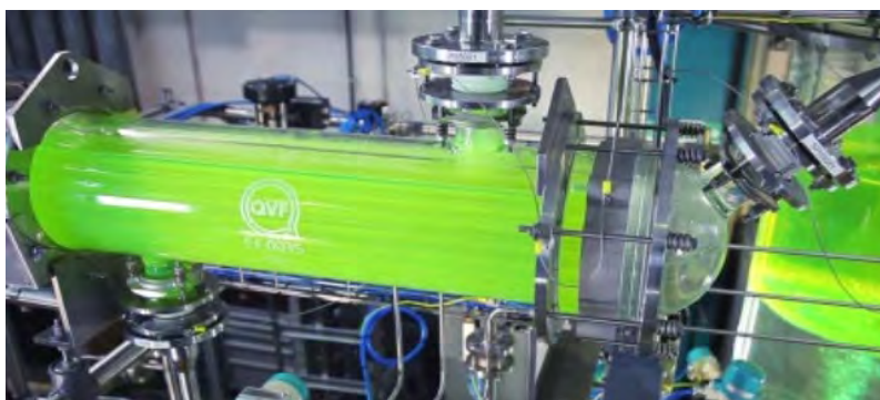
SI. 1.3. Stakleni dobošasti razmenjivač toplote, DE DIETRICH process systems, France
