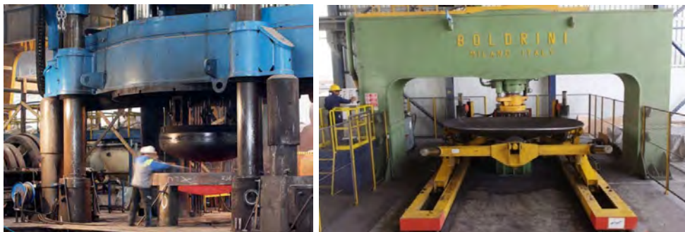
Sl. 1.95. Toplo presovanje danaca na presi Siempelkamp (Nemačka) 150 MN – levo, desno – Boldrini (Italija) mašina za rolovanje danaca prema DIN, NF ili ASME.
