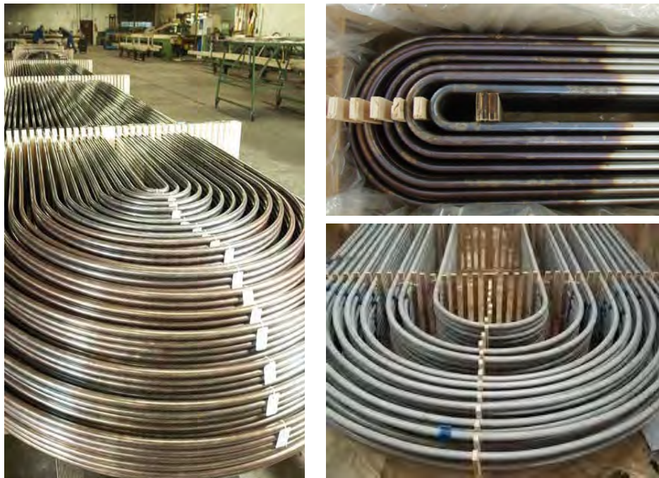
Sl. 1.102. Paketi U cevi složeni prema prečniku cevi i prema poluprečniku savijanja, TPS Technitube (Nemačka). Gornja desna slika prikazuje toplotno obrađene U-cevi. Detalji toplotne obrade (žarenje) mogu se videti u AD-Merkblatt HP 7/3 [S8].
