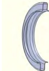
Sl. 4.9. Kompenzatori sa U-mehom, crtež i oznake prema EN 13445. desno: Kompenzatori s debelim zidom za razmenjivače toplote, U.S. Bellows, Inc. USA
