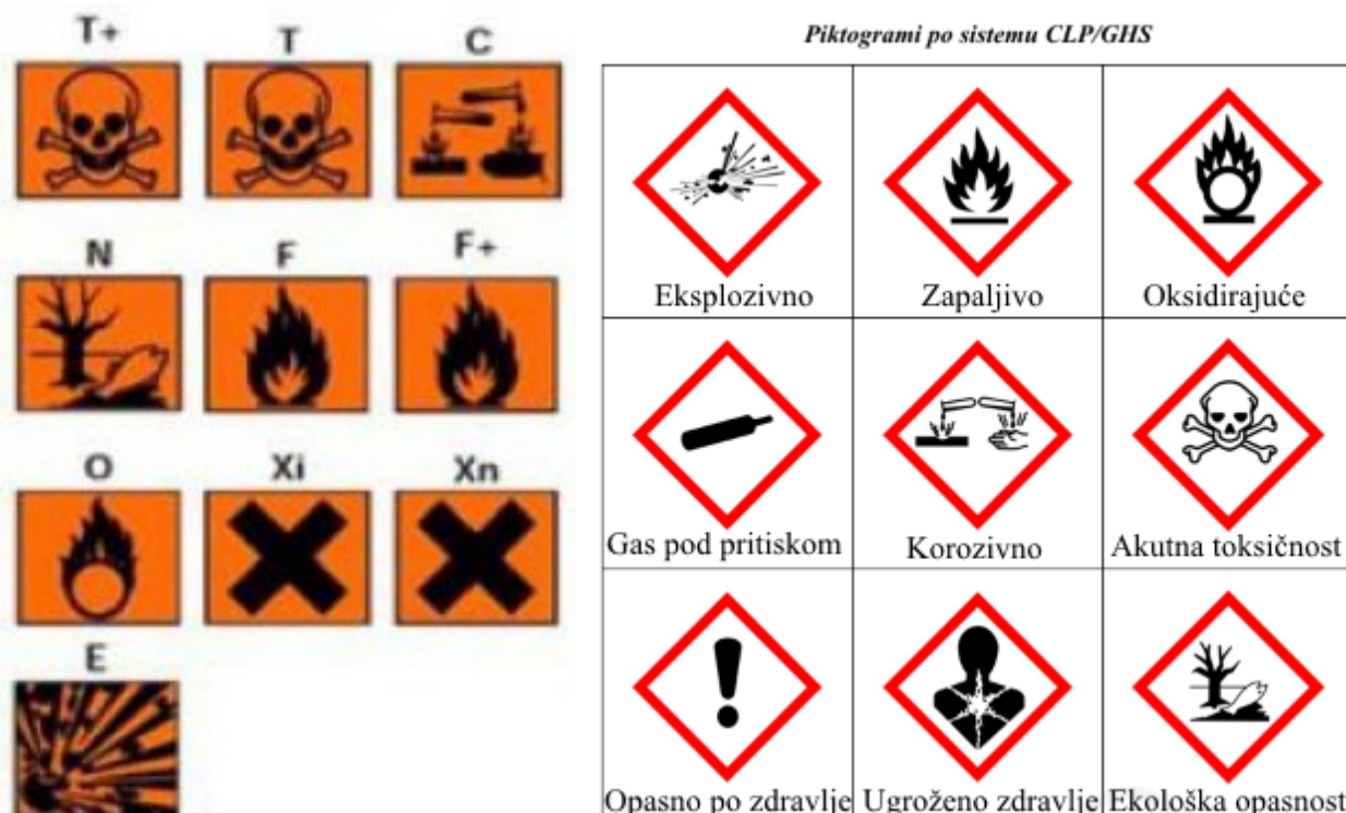
Slika 1. Piktogrami opasnih materija. Levo piktogrami koji su korišćeni u direktivi 97/23/EU, Desno su piktogrami koji se koriste u novoj PED direktivi 2014/68/EU i Regulativi CLP 1272/2008.
