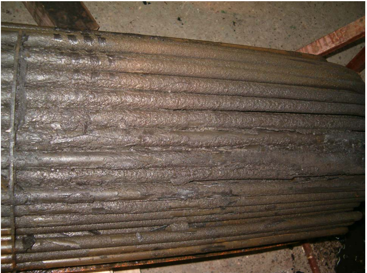
Slika br. 12 Detalj taloga mulja na cevnom registru, u zoni ravnog danca.
