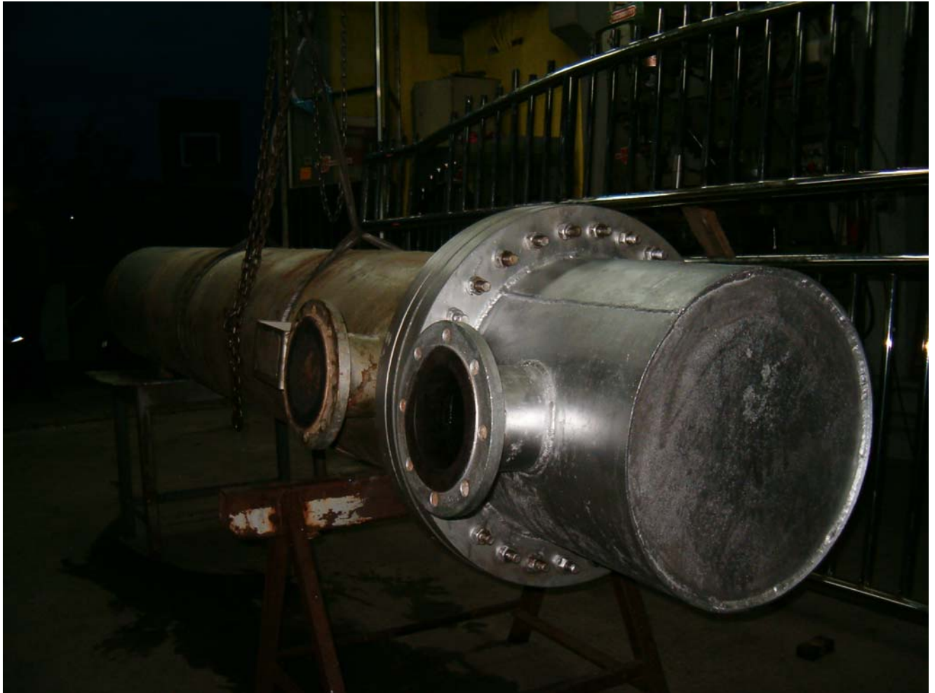
Slika br. 16 Razmenjivač toplote posle završetka servisa, spreman za isporuku.
