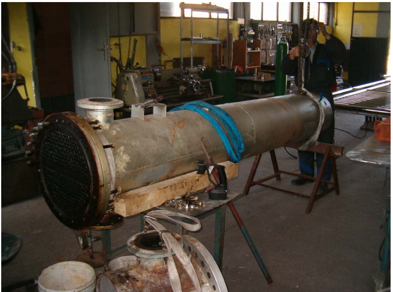
Slika br. 1 Cedenje zaostalog termo ulja, podizanjem zadnjeg kraja razmenjivača toplote.
