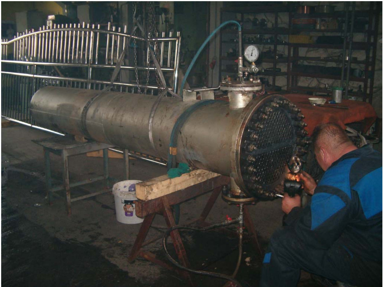
Slika br. 15 Detaljni pregled cevne ploče lupom posle kontrolnog ispitivanja na HVP – 9 bara
