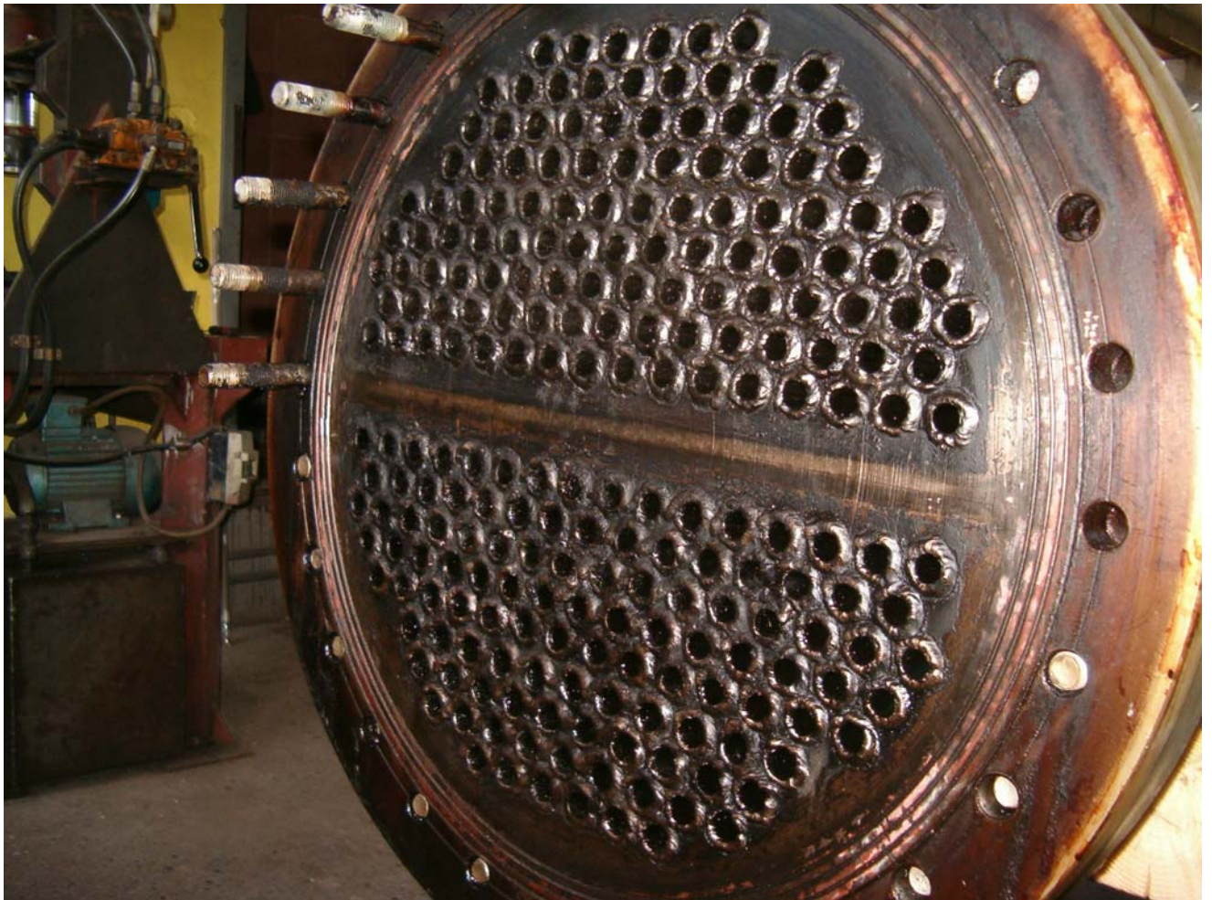
Slika br. 2 Izgled cevne ploče, posle završetka ceđenja.
