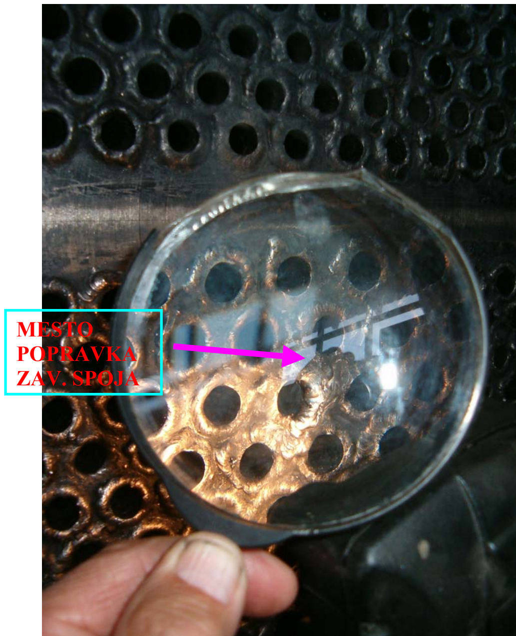
Slika br. 9 Detalj cevne ploče pri pregledu sa mestom popravke zavarenog spoja.
