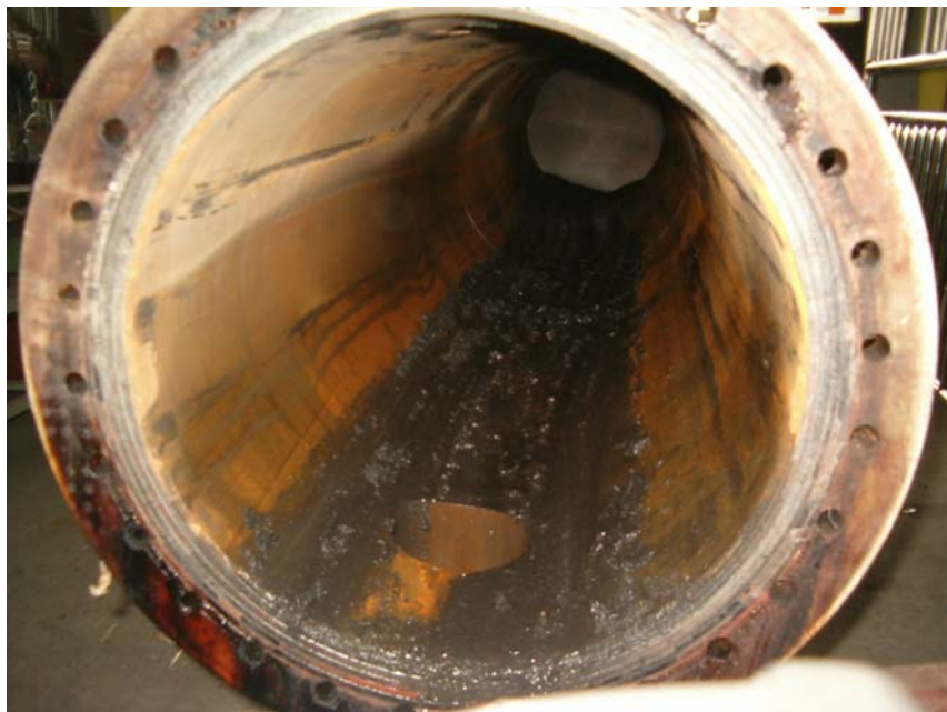
Slika br. 11 Talog mulja u omotaču RT 0519.
