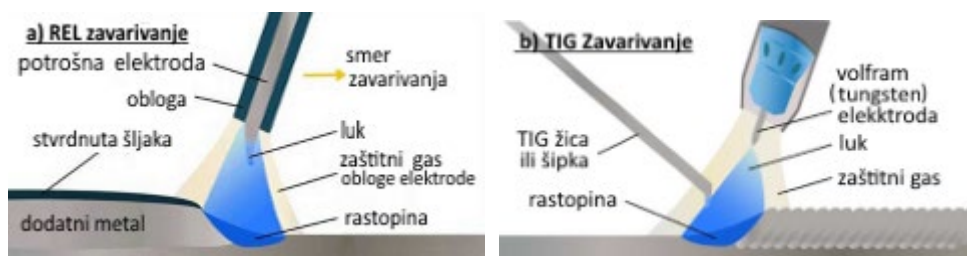
Sl. 2.22. a) Ručno elektrolučno zavarivanje, b) TIG zavarivanje žicom u zaštiti argona
